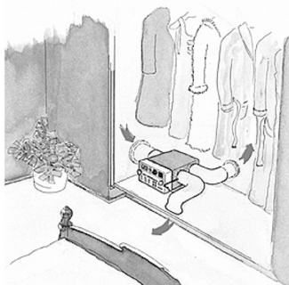
Циркуляция теплого воздуха увеличивается при более низком расположении нагревателя.
